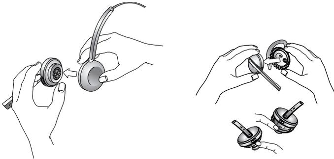
Abbildung 28: Trageformbefestigung vom Headset lösen
