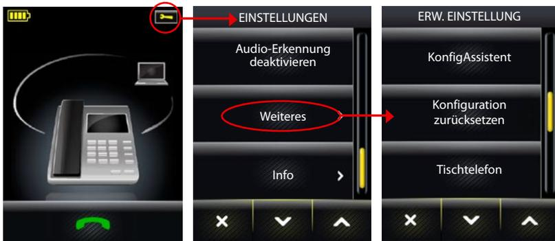
Abbildung 40: Zugriff auf den Konfigurationsassistenten
